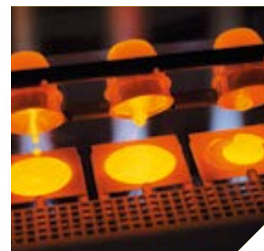
— Matériaux en fusion pour la préparation d'une «perle» destinée à une analyse fluorescence X au laboratoire matériaux et microstructures de l'Isle d'Abeau (France).
