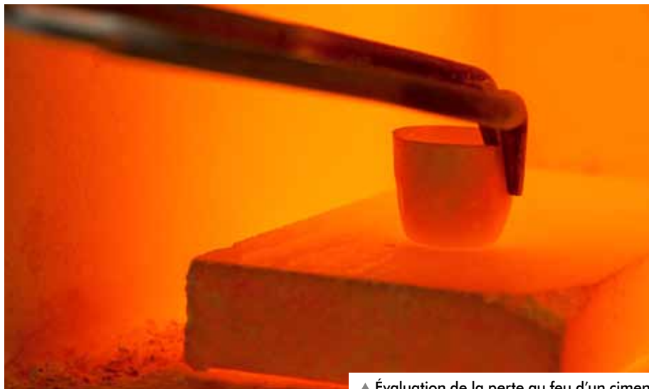
▲ Évaluation de la perte au feu d'un ciment pour déterminer la quantité de calcaire.
