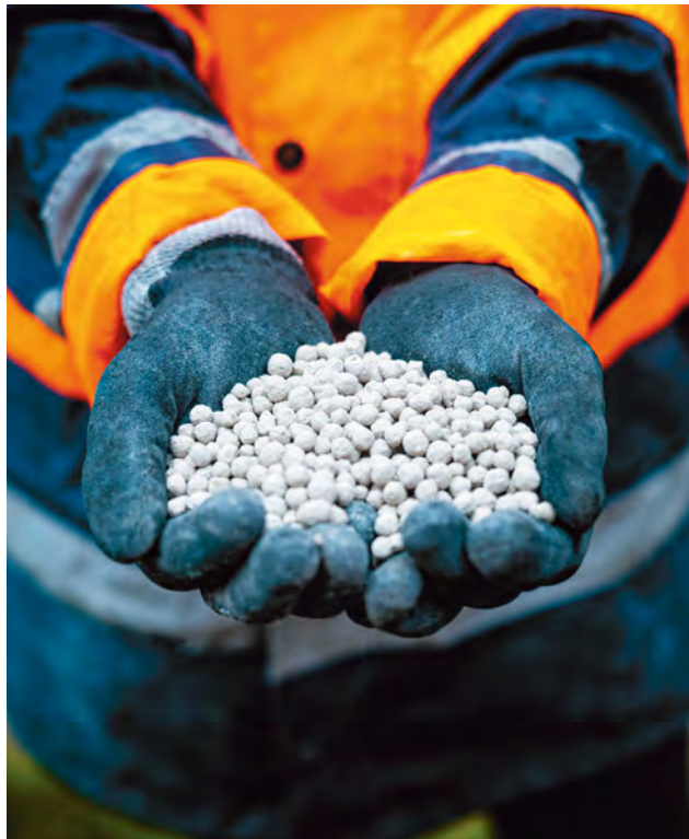
Granulats légers obtenus grâce au dispositif CO 2 ntainer.
