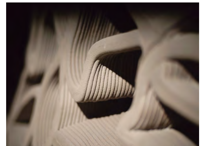
Élément béton imprimé en 3D.
