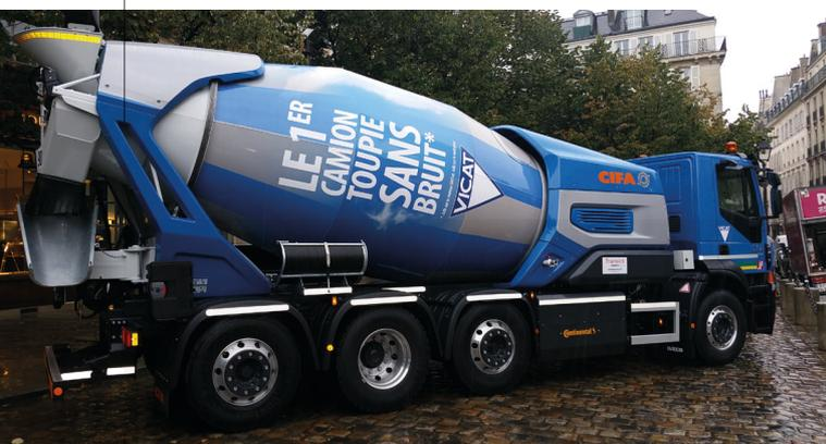
**LE VÉHICULE NOVATEUR DISPOSE D'UN MOTEUR GNV DEUX FOIS MOINS BRUYANT QU'UN MOTEUR TRADITIONNEL.**
